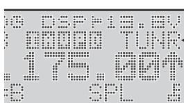
TUNR : アンテナチューナー動作中に点灯します.
